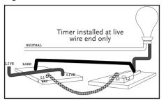
YELLOW & GREEN EARTHS MUST REMAIN CONNECTED TO METAL BOX
