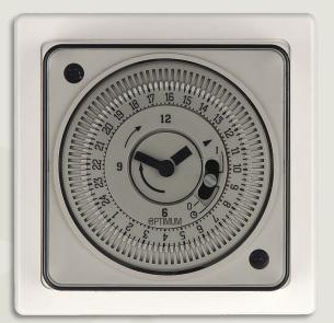
OP-SBST IS A CAPTIVE-TAPPET 24-HOUR TIME SWITCH. EACH TAPPET OPERATES FOR 15 MINUTES. THE TIMER IS SUITABLE FOR INSTATLLATION ON A SURFACE OR IN-WALL PATTRESS BOX. THE 24 HOUR DIAL CONTROLS A VOLT-FREE CHANGEOVER SWITCH, WITH A RESISTIVE RATING OF 16 AMPERES.
